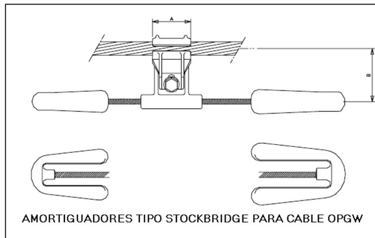
Los amortiguadores se utilizan en vanos largos mayores a 120 metros aprox. y/o cuando la tensión del cable excede el 15% de la tensión última de ruptura calculada y existe un viento laminar prevaleciente entre 3 y 30 km/hora deberán ser apropiados para amortiguar efectivamente la vibración eólica en un rango de frecuencias que puedan producir daños al cable ADSS y herrajes. Deberán ser suministrados con todos sus elementos para su montaje.
