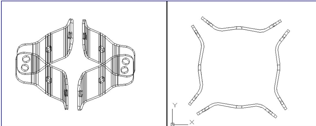
El diámetro (D) de 10 ½ pulgada deberá ser medido cuando la abrazadera tenga abierta todos sus pernos extendidos en una longitud de 35 mm o 1 ½ pulgada, tal como se ilustra en la figura adjunta. Además, cada platina de acero tendrá una perforación cuadrada de diámetro de ¾ de pulgada.
