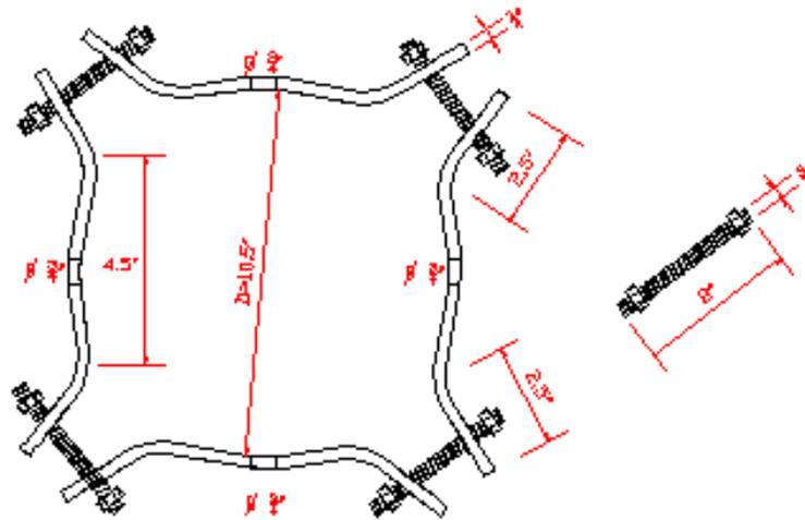
La abrazadera doble tendrá un diámetro interior (D) de  $10\frac{1}{2}$  pulgadas y será construida con platina de acero estructural galvanizada en caliente de  $1\frac{1}{2}$  pulgadas de ancho por  $\frac{1}{4}$  pulgadas de espesor, provista de 2 pernos de rosca corrida de  $\frac{5}{8}$  pulgadas de diámetro y 6 pulgadas de longitud. Cada perno estará provisto de dos arandelas circulares y dos tuercas hexagonales de ajuste galvanizadas.
