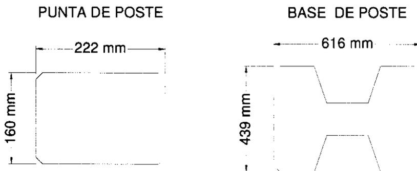
Para los postes de 21 m (tanto el de 1,600 como el de 2,400 Kg de carga de rotura) las dimensiones base disminuirán en la base pero de manera poco significativa, mientras que en la punta se mantiene igual.
