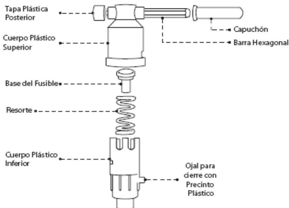
Especificaciones Técnicas Generales de un Fusible Neozed para Portafusible de Redes Preensambladas.
