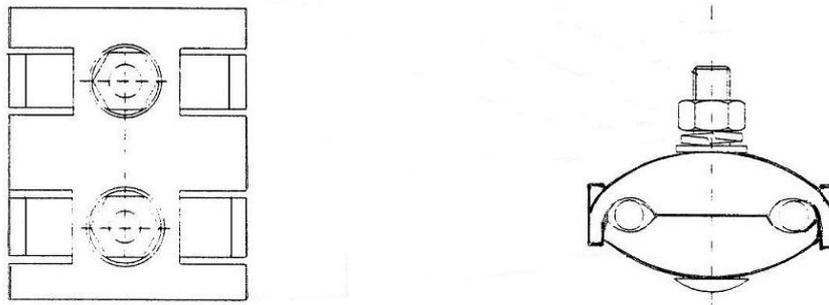
Para la selección del rango del conector, se deberá considerar que el mismo será instalado sobre las varillas de armar del cable OPGW de un lado y del otro lado, al conductor de puesta a tierra bajante tipo AAC.
