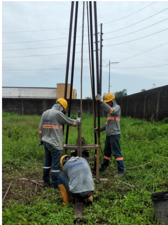
Figura 4. Fotografía durante la ejecución del sondeo mediante el ensayo SPT.
