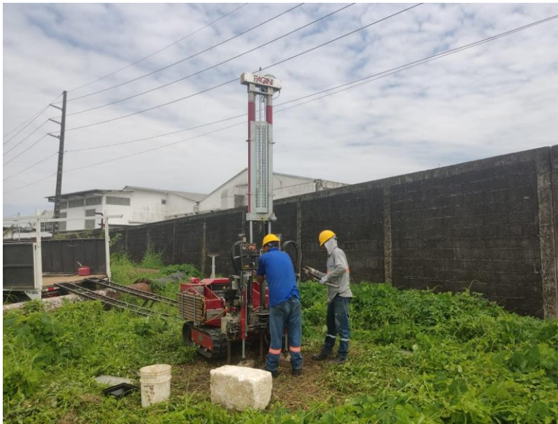
Figura 5. Fotografía durante la ejecución del sondeo mediante el ensayo CPTu.
