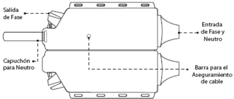
**Especificaciones Técnicas Generales de una Pinza de Acometida Cliente para de Redes Preensambladas.**
