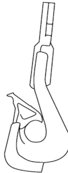
**Especificaciones Técnicas Generales de una Ménsula de Acometida para postes de Redes Preensambladas.**
