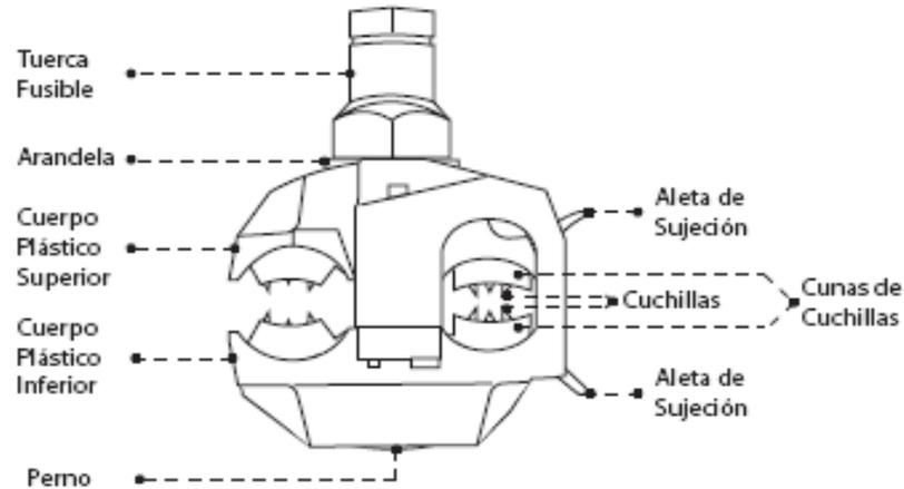
**Especificaciones Técnicas Generales de un Portafusibles Aéreo Encapsulado para Usarse en Redes Preensambladas.**
