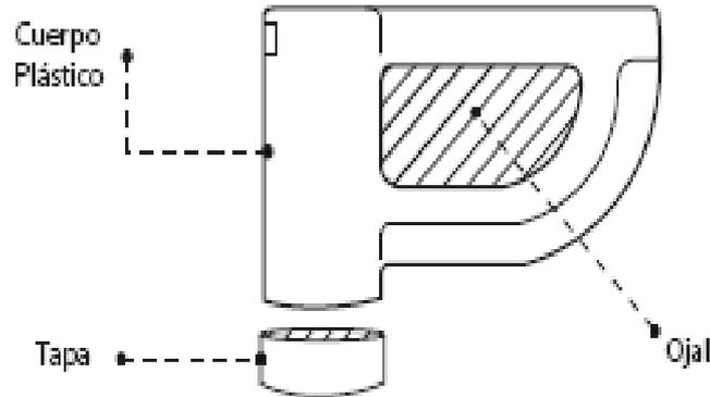
**Especificaciones Técnicas Generales de una Ménsula de Acometida para Fachada de Redes Preensambladas.**
