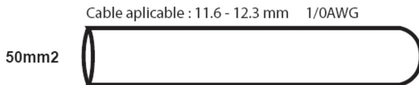
Especificaciones Técnicas Generales de un Conector Simple
