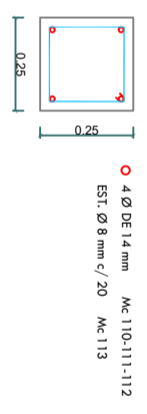
DETALLE DE VIGAS SUPERIORES E INFERIORES escala 1:10
