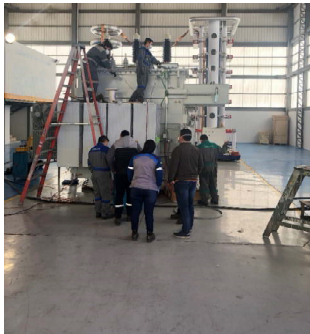
PRUEBAS FAT CNEL 20/25 MVA 69/13.8 KV
