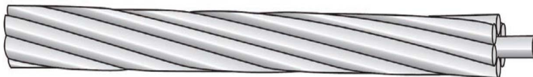
CONDUCTOR DESNUDO DE ALUMINIO AA (1350 H-19) REFORZADO CON ACERO GALVANIZADO
