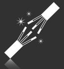
Mantenga sus electrodomésticos y aparatos electrónicos en buen estado. Conductores en mal estado pueden energizar las partes metálicas del aparato y producir un choque eléctrico en el usuario.
